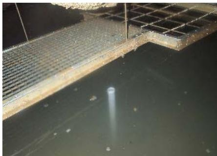
*Grille suspendue au-dessus de la rivière souterraine permettant de prélever et mesurer le sédiment sans marcher dedans.*
