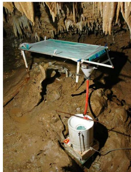
*Installation de mesure du débit des stalactites permettant de tester l'efficacité du système d'injection d'eau mis en place pour limiter l'impact de la route.*
